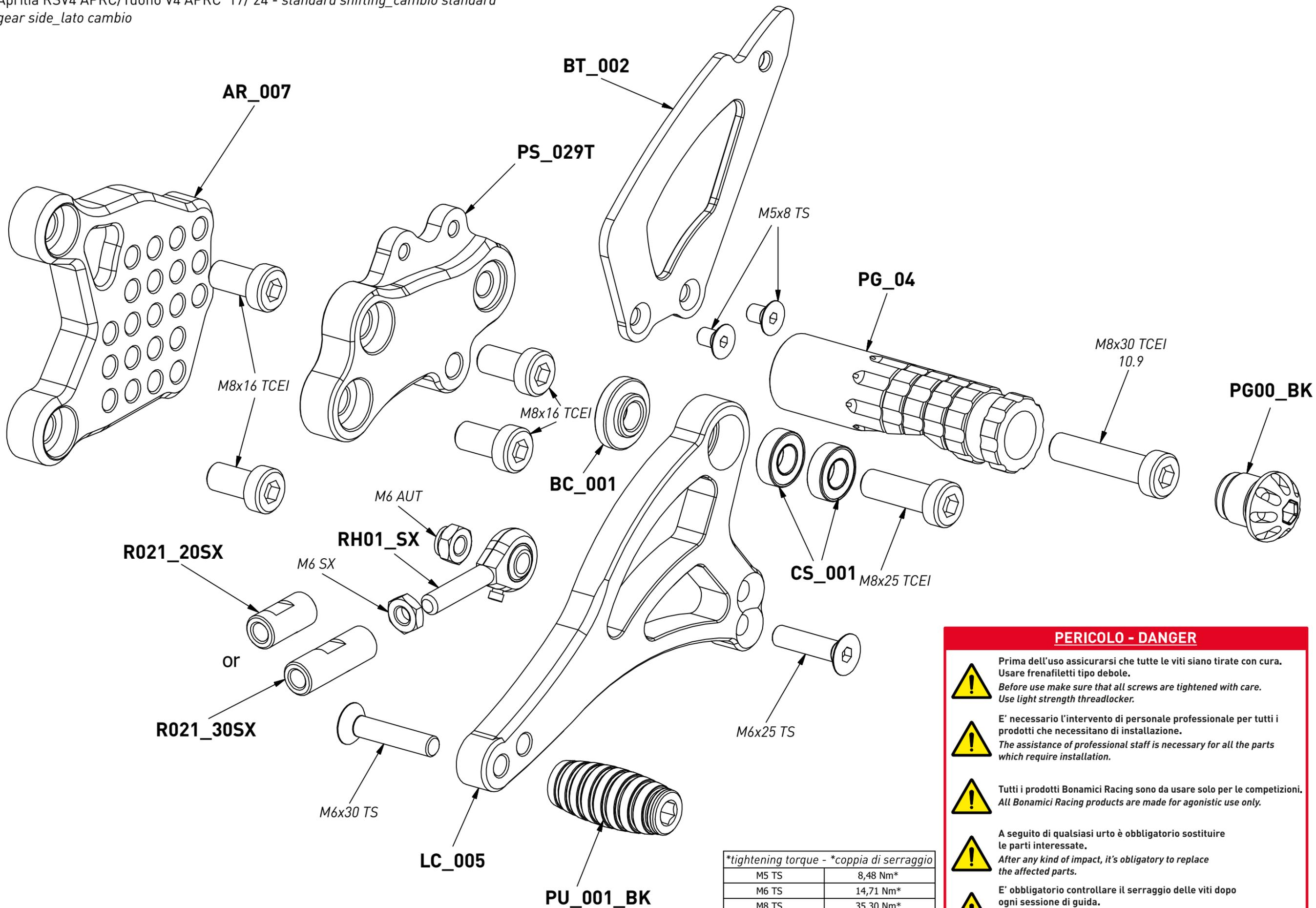
\*tightening torque - \*coppia di serraggio
